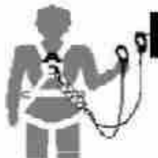
اشکال ۱۱۲- نحوه بستن استوار در ارتفاع با ابزار منوط کننده
