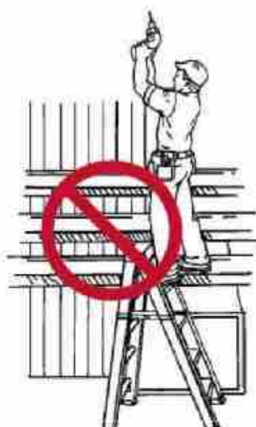
شکل ۱۴- نحوه استقرار غلط برای کار
