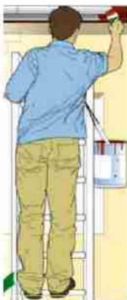
شکل ۱۳- نحوه استقرار صحیح برای کار
