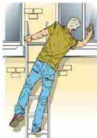
شکل ۱۱- استقرار غلط برای کار
